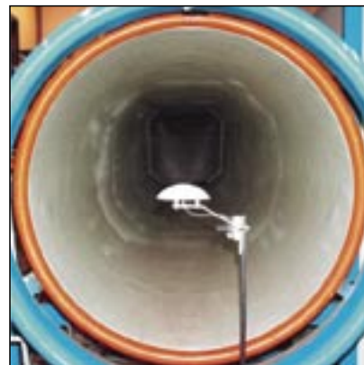
Presse di pressione statica collocata nella galleria aerodinamica
