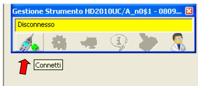
Se la connessione avviene correttamente appare il seguente messaggio. In caso contrario controllare la connessione seriale del PC e le impostazioni dello strumento secondo quando indicato nel manuale di istruzioni
